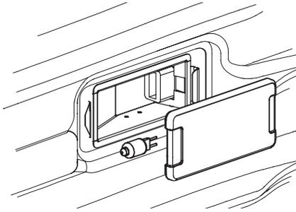
**REMARQUE :** Pour éviter d'endommager ou de réduire la longévité de l'ampoule neuve, ne pas toucher l'ampoule avec les doigts nus. Porter des gants en coton ou utiliser de l'essuie-tout lors du remplacement de l'ampoule.
